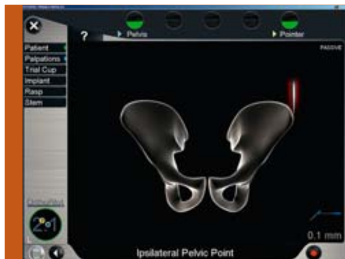
OrthoPilot® referencing of the anterior pelvic plane
